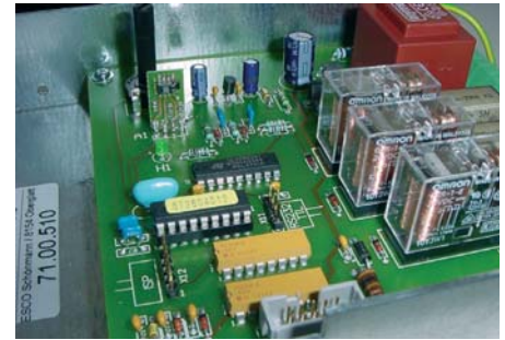
Bild 2: Blick in die Steuerung mit den Feuchte- und Temperatursensoren SHTxx basierend auf der CMOSens-Technologie
